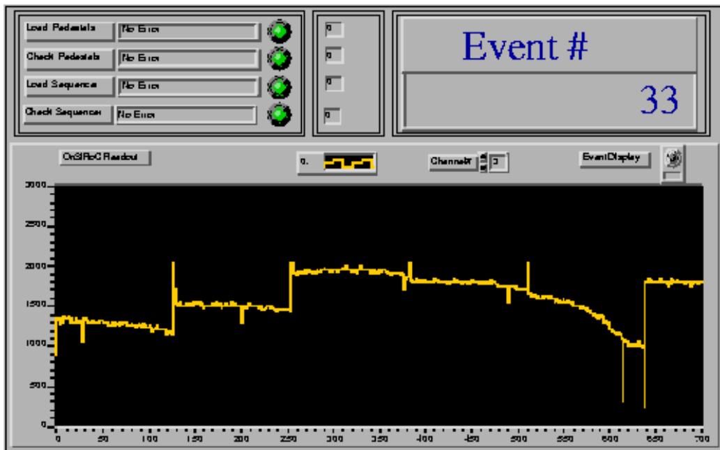
Abbildung 4.7: Das FrontPanel der Steuersoftware. In diesem Abschnitt befindet sich das Online-Display. Man erkennt darauf die Grenzen zwischen den APCs als Stufen, und rechts das Ende der Auslese als Plateau.
