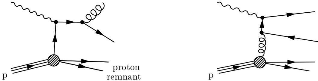
**Abb. 2.3:** Zwei mögliche Diagramme für direkte Photonen in niedrigster Ordnung QCD: *links* QCD Compton-Streuung, *rechts* Photon-Gluon-Fusion.
