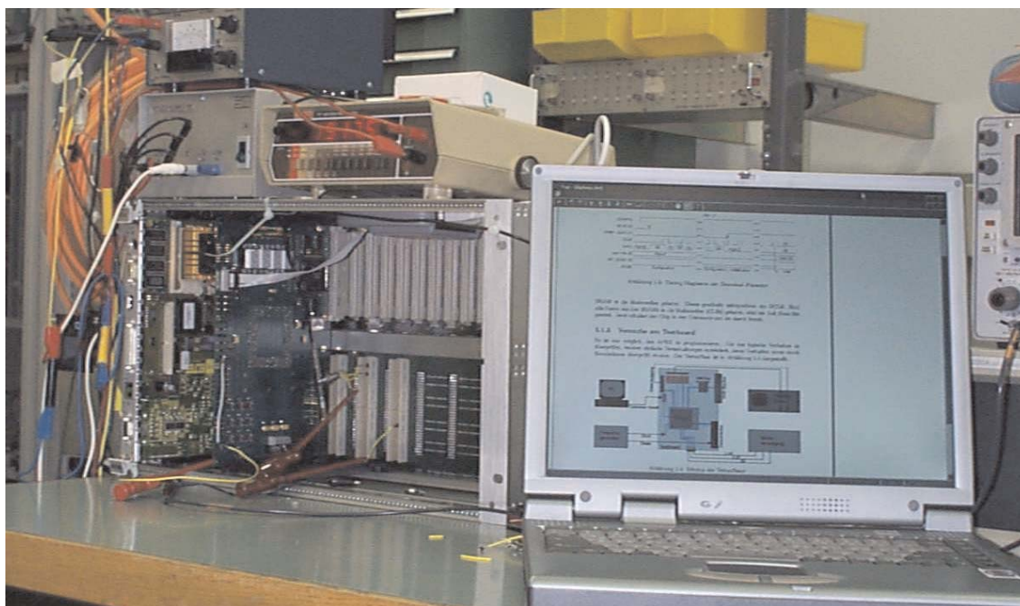
Abbildung 6.6: Der Testaufbau; das Testrate mit dem Testboard ist im linken Teil des Fotos zu erkennen.
